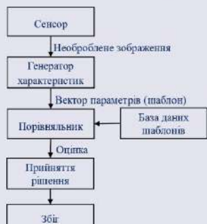
Рисунок 4 – Типова система аутентифікації за геометрією кисті
