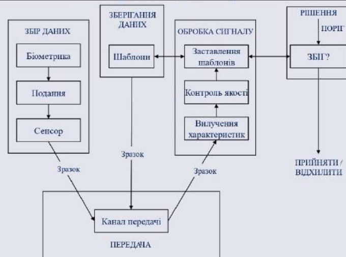
Рисунок 9 – Базова структура системи біометричної аутентифікації
