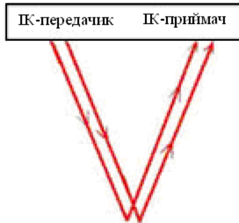
Рисунок 3.2 – Вертикальний інфрачервоний лічильник для підрахунку людей в кімнатах
