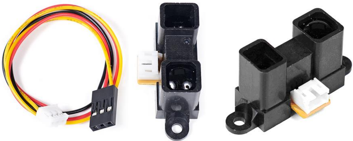
Рисунок 2.3 – Зовнішній вид інфрачервоного далекоміра GP2Y0A02YK та кабелю до нього
