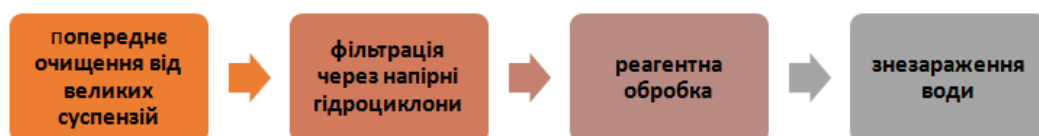
Рисунок 3.1 – Послідовність очищення шахтної води
