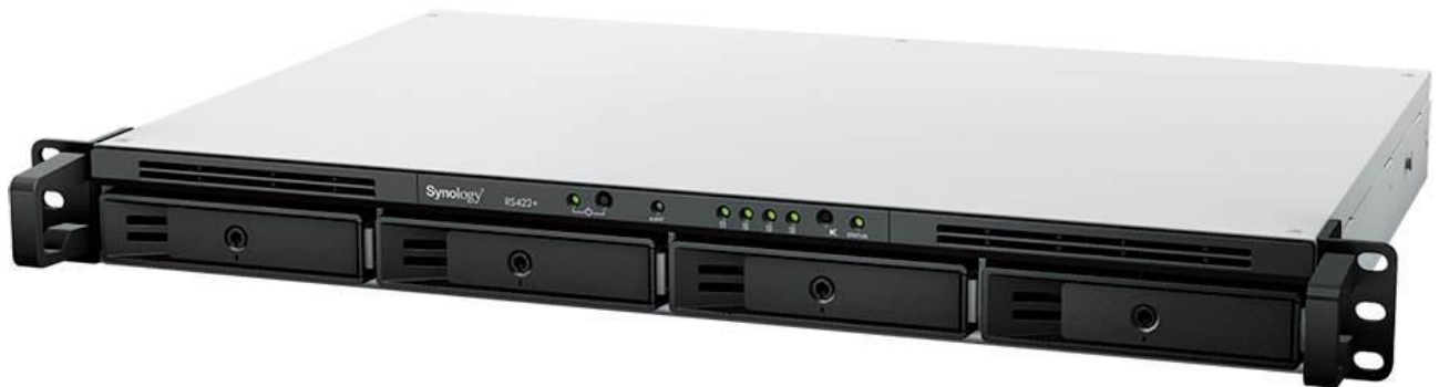
Рисунок 3.8 – NAS-сервер Synology RackStation RS422+
