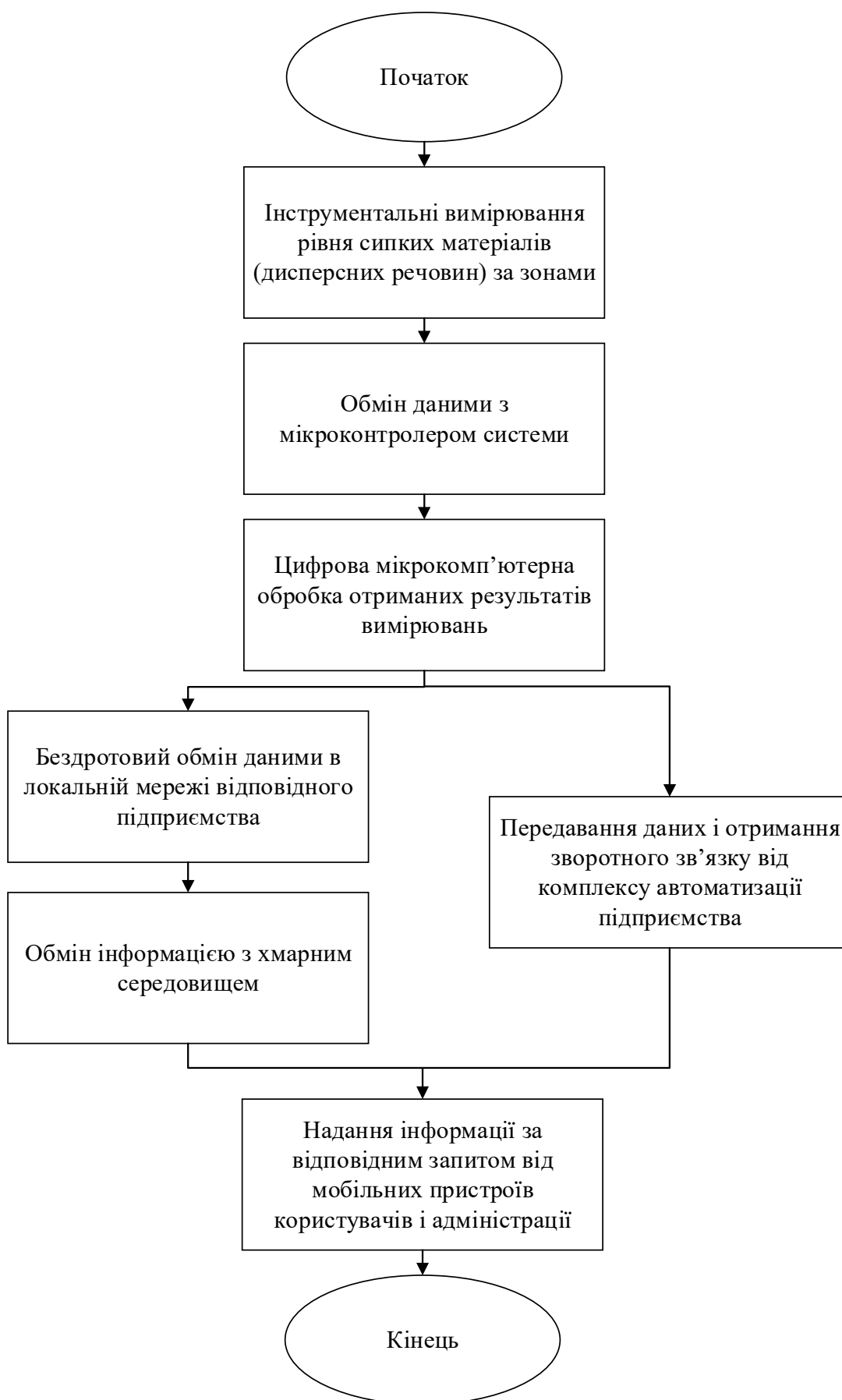
Рисунок 2.4 – Блок-схема сформульованого алгоритму роботи комп'ютерної технології моніторингу рівня сипких матеріалів (дисперсних речовин)
