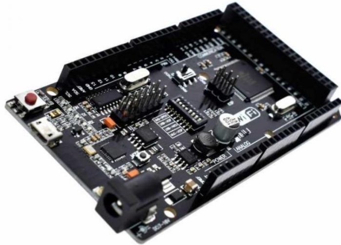
Рисунок 2.9 – Фото зовнішнього виду мікропроцесорної плати Arduino Mega R3 2560 з інтегрований модулем ESP 8266 Wi-Fi
