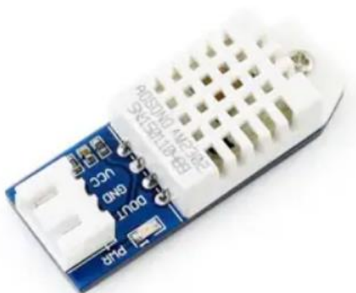
Рисунок 2.7 – Фото зовнішнього виду датчика температури-вологості Waveshare DHT 22
