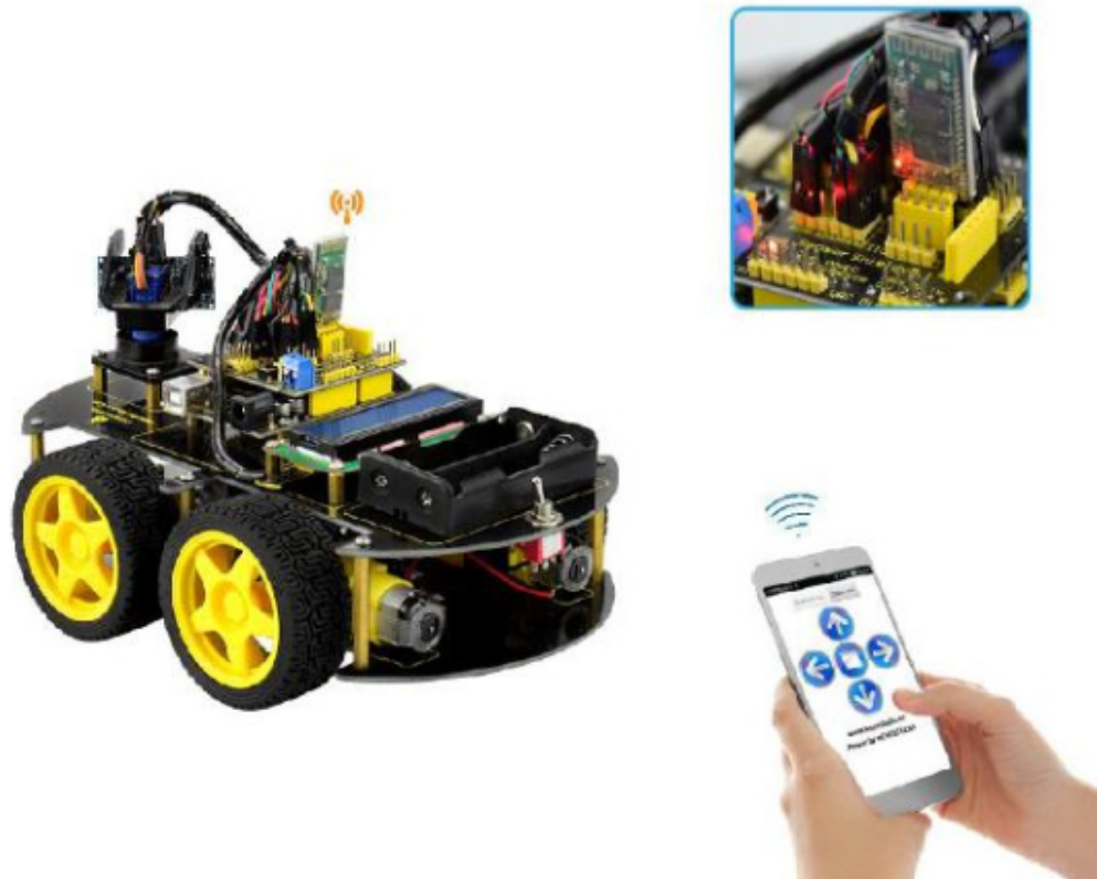
Рисунок 3.4 – Можливість здійснення дистанційного керування мобільного пристроєм зі застосуванням пульта керування
