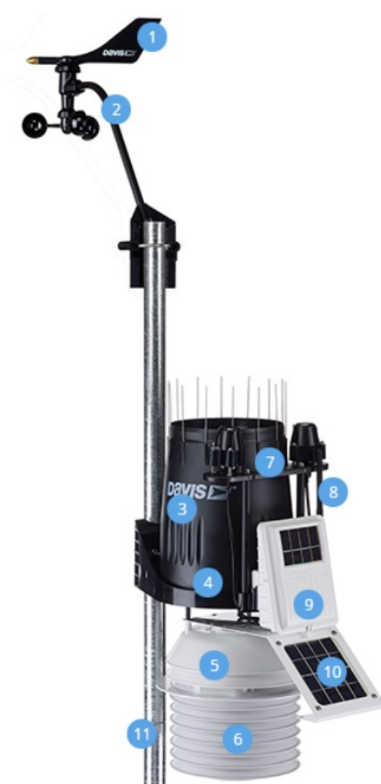
Рисунок 2.6 – Зовнішній вигляд професійної портативної комп'ютерної метеостанції Vantage Plus Pro 2 від фірми Davis Instruments [12]
