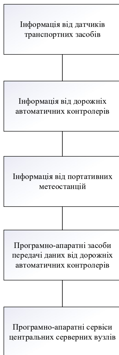
Рисунок 2.11 – Рівні SCADA-систем автотранспортного призначення
