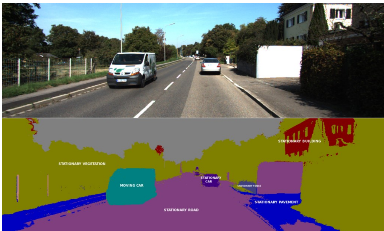
Рисунок 1.5 – Приклад графічної сегментації транспортних засобів під час дорожнього трафіку
