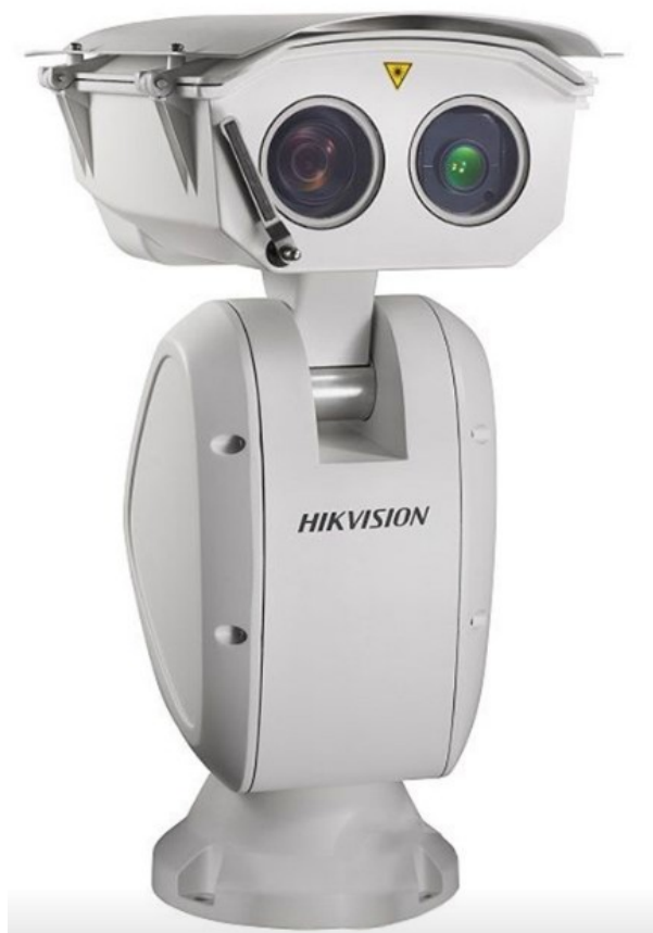
Рисунок 2.4 – Зовнішній вид професійної інтелектуалізованої IP-відеокамери Hikvision Speed Dome моделі DS-2DY9188-AIA [11]
