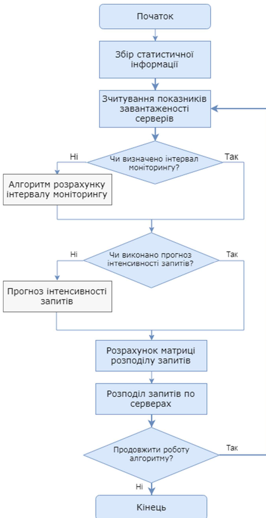
Рис. 4.3. Блок-схема алгоритму управління вхідним потоком
