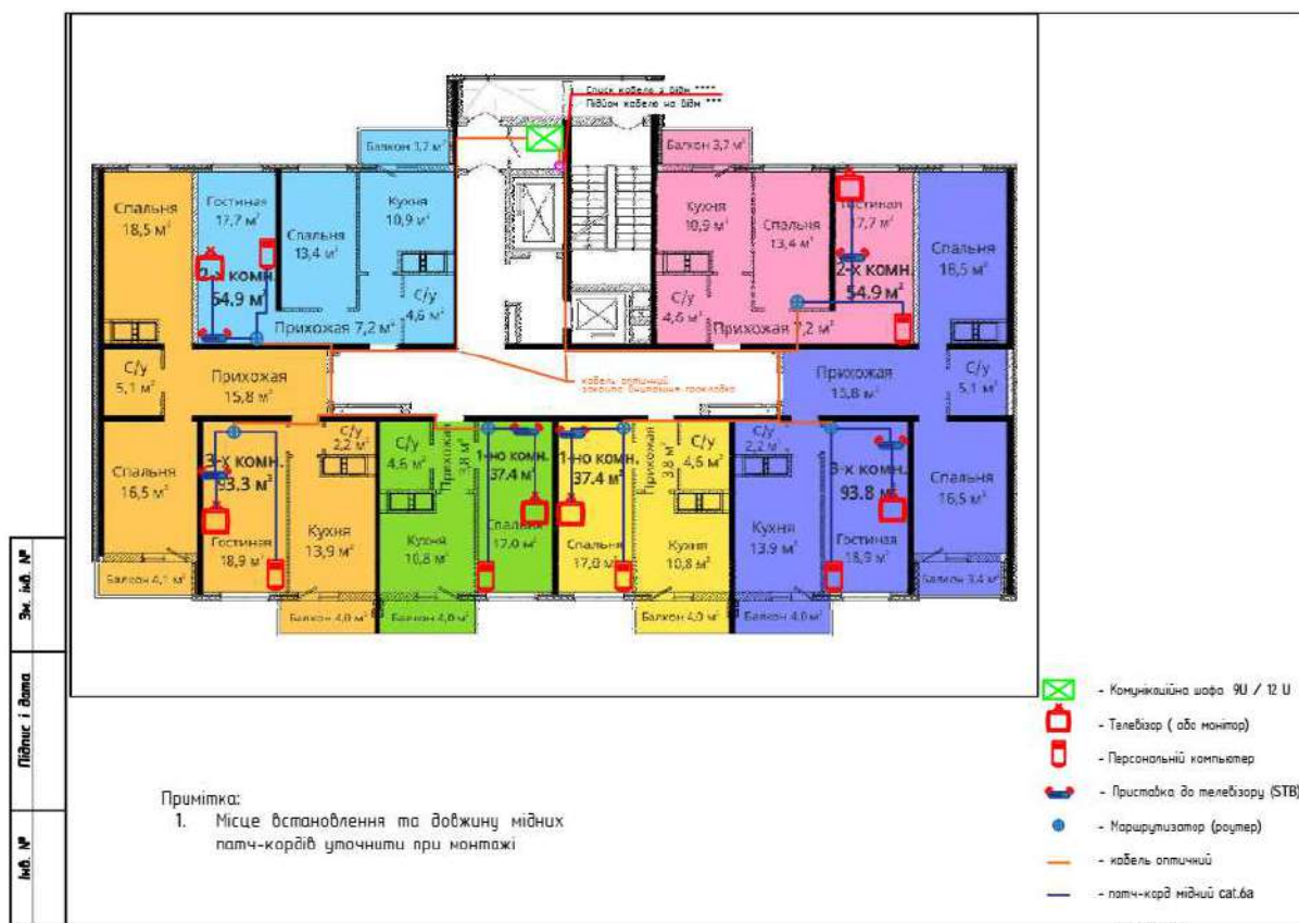
Рисунок Д.3 – Розташування обладнання. Типовий поверх
