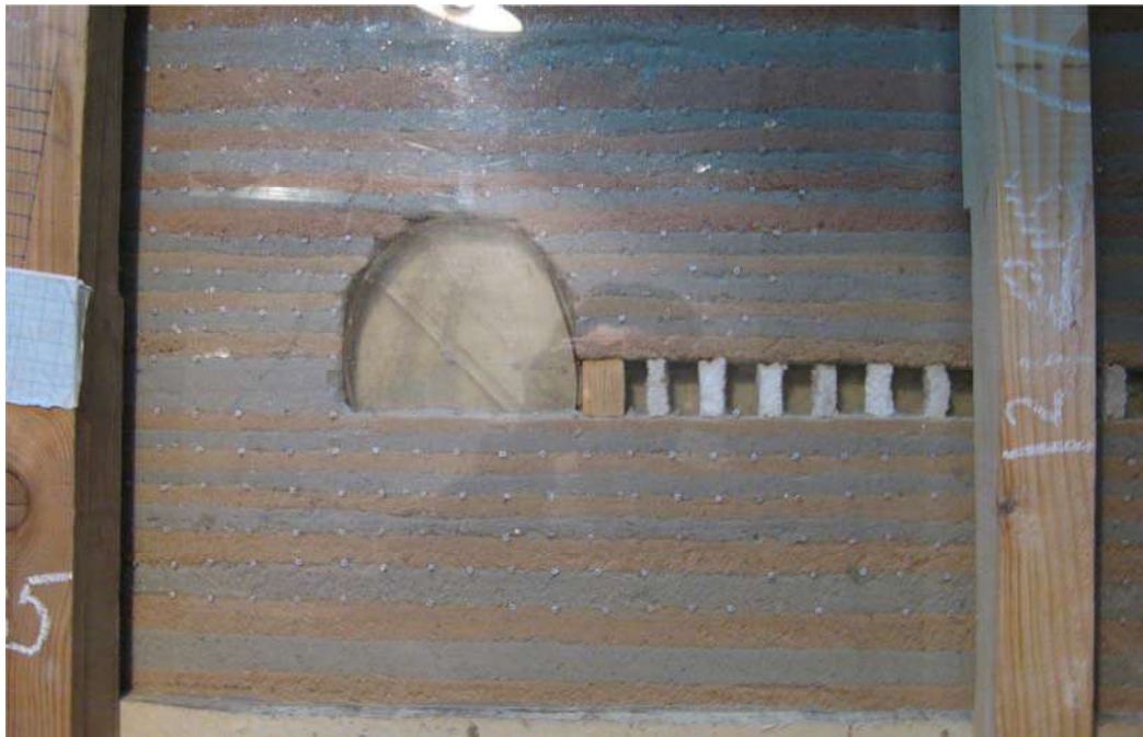
Рисунок 2 - Общий вид стенда для плоского моделирования методом эквивалентных материалов
