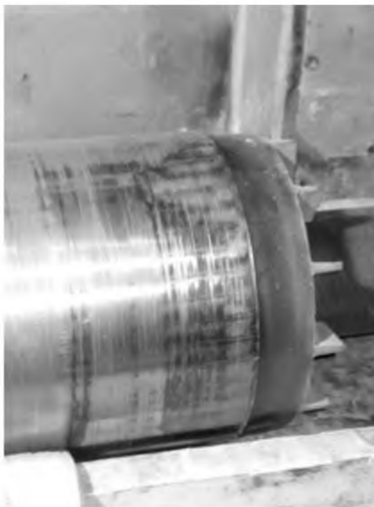
Рисунок 2.4 – Перегрів поверхні короткозамкненого ротора [9]
