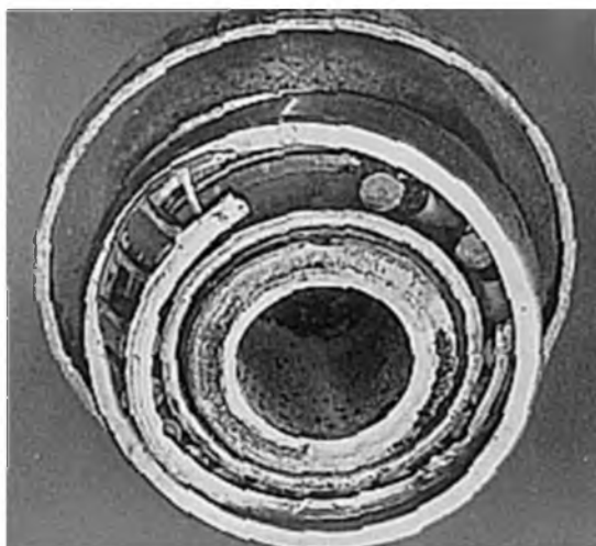
Рисунок 2.7 – Ушкоджений в результаті блукаючих струмів підшипник [9]
