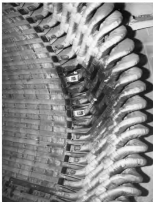
Рисунок 2.3 – Виникнення контакту між статором і ротором через ушкодження підшипника з наступним коротке замикання обмотки в гнізда статора [9]
