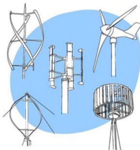
Рисунок 2.8 – Види технічних рішень вітрогенераторної установки
