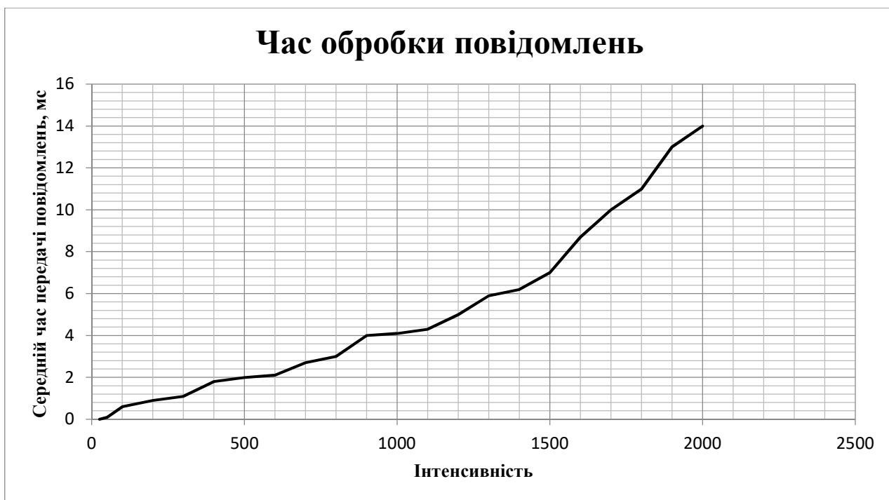
Рисунок 4.7 – Результат залежності часу обробки повідомлення від інтенсивності надходження пакетів
