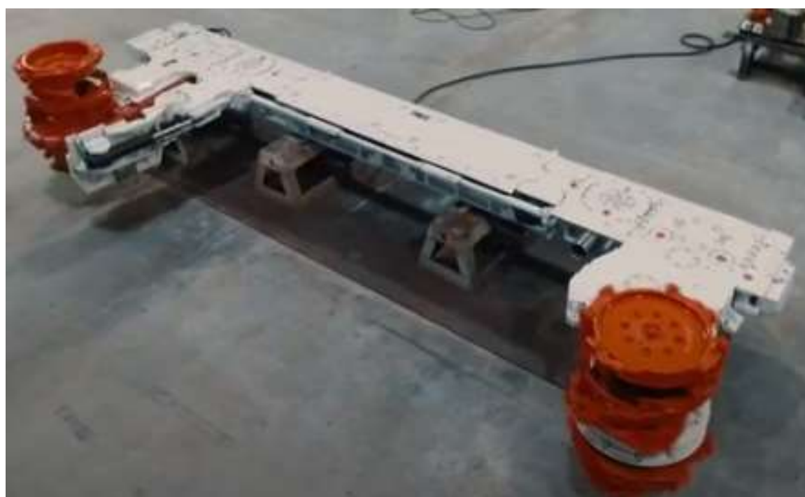
Рисунок 1.2. – Комбайн К200 з барабанними виконавчими органами
