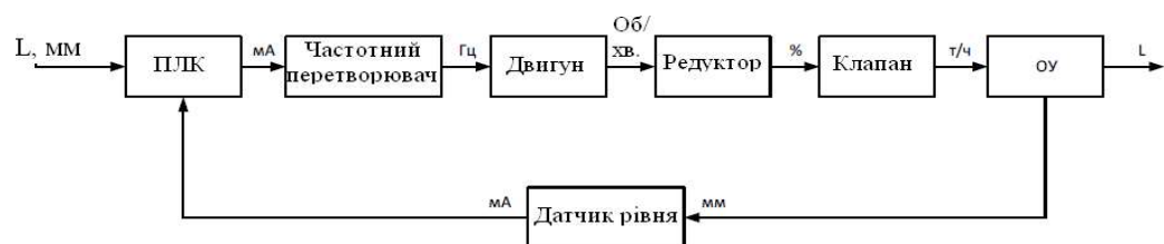
Рисунок 2.4 – Модель системи контролю рівня в резервуарі
