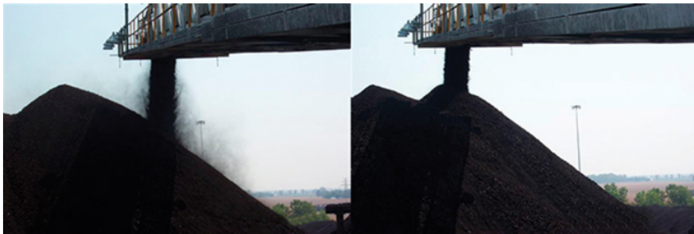
Рисунок 1.2 – Зліва звичайне вугілля. Справа – вугілля оброблене ПАР
