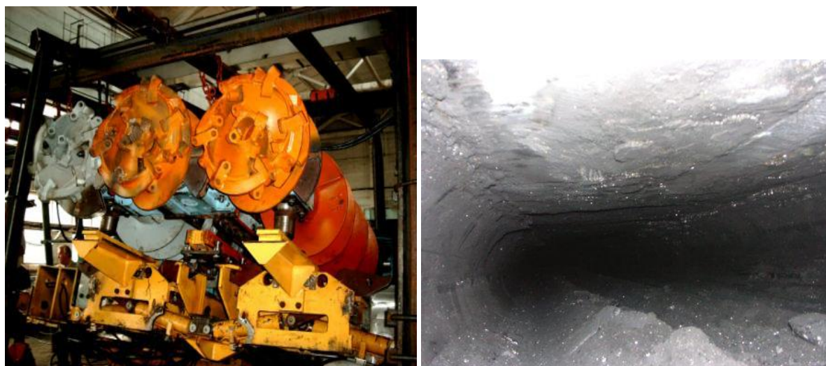
Рис. 2. Бурошнековый комплекс КБВ (а) и пробуренная скважина (б)
