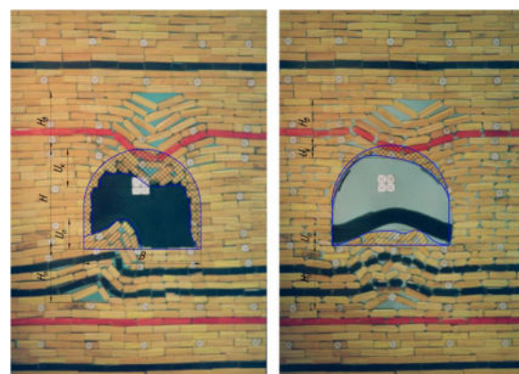
а) модель без кріплення; б) модель з арочним кріпленням
