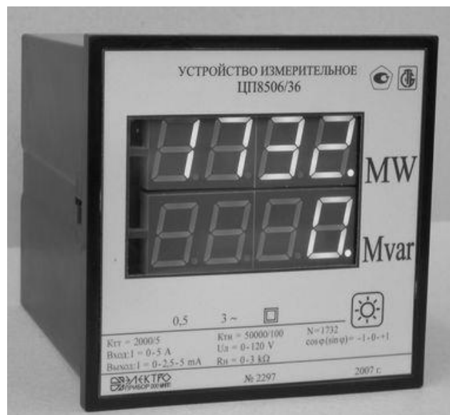
Рисунок 7.1 – Приклади лабораторного і промислового ватметрів
