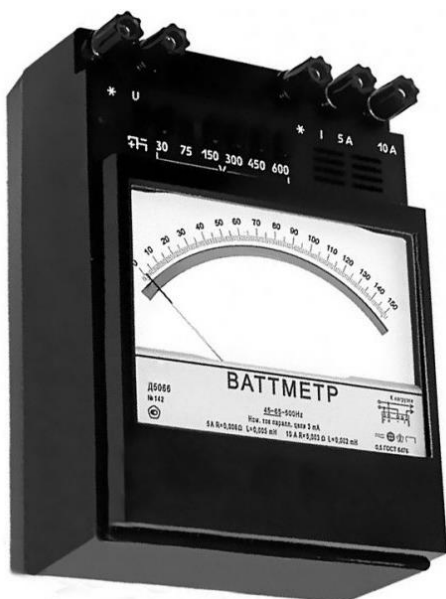
Рисунок 7.1 – Приклади лабораторного і промислового ватметрів
