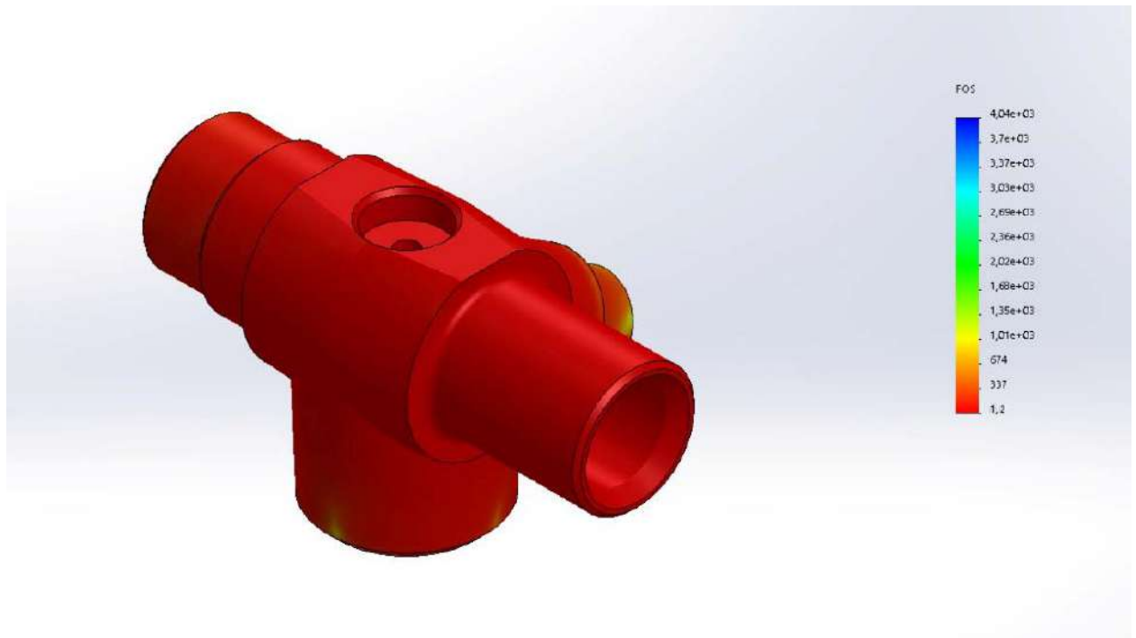
Рисунок 2.4 – Розрахункова схема щодо визначення запасу міцності корпусу P30.00.921
