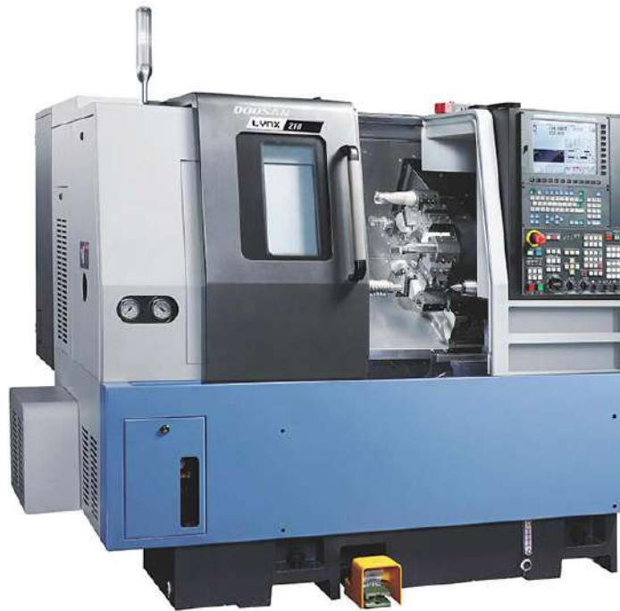
Рисунок 3.3 – Зображення токарного центру Doosan Lynx-220MC
