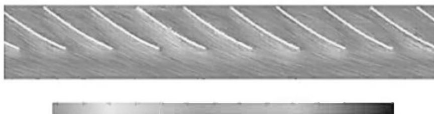
Рисунок 4.13 – Розподіл тисків на лопатях при режимах роботи турбомашини близьких до номінальних значень
