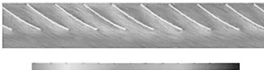
Рисунок 4.12 – Розподіл тисків на лопатях при режимах роботи турбомашини вищих за номінальні значення
