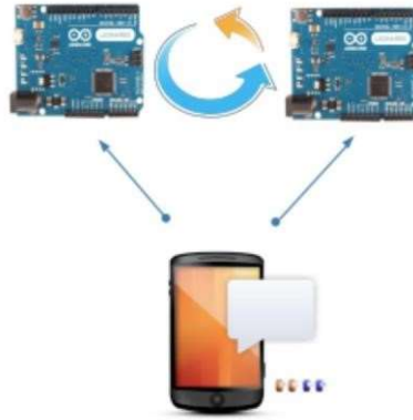
Рисунок 1.2 – Діаграма, що представляє принцип роботи вбудованої системи без центрального контролера
