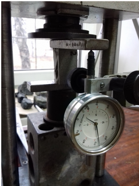
Рисунок 2.9 – Процес проведення випробування зразків пісковика на повзучість при стисканні
