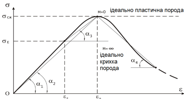
Рисунок 1.1 – Графік до розрахунку модуля пластичності зразка гірської породи.
