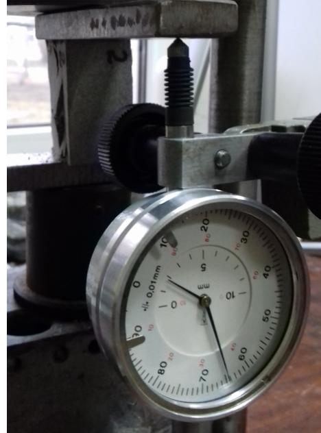
Рисунок 2.8 – Установка випробування зразків на повзучість
