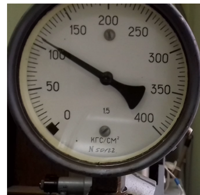
Рисунок 2.9 – Процес проведення випробування зразків пісковика на повзучість при стисканні
