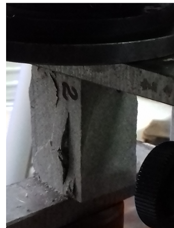
Рисунок 2.8 – Установка випробування зразків на повзучість
