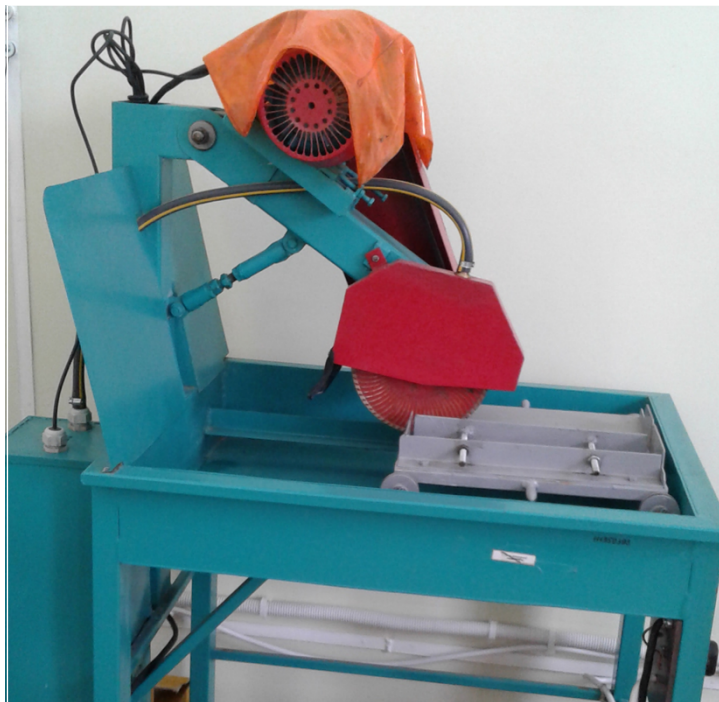
Рисунок 2.1 – Верстат для обробки природного каменю
