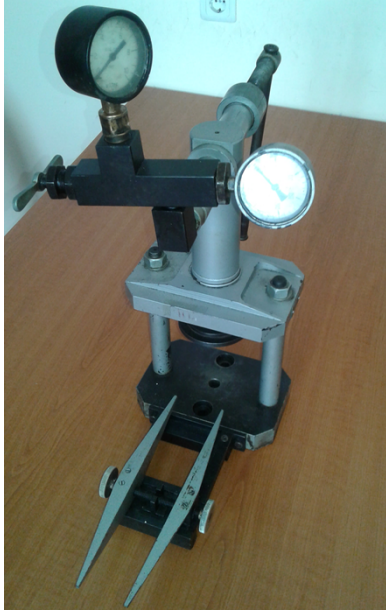
Рисунок 2.7 – Гвинтовий ручний гідравлічний прес БП-29
