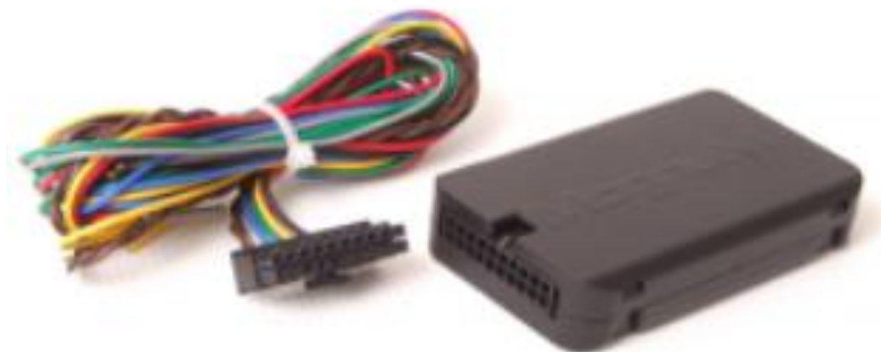
Рисунок 2.4 – Зовнішній вигляд GPS-трекера Magnum MT-500S
