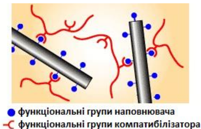
Рисунок 4.15 - Механізм дії скріплюючого агента в композиційному матеріалі
