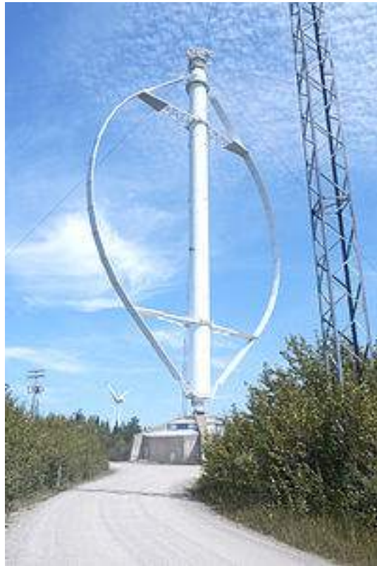
Рисунок 1.5. - Турбіна з вертикальною віссю (турбіна Дар'є)
