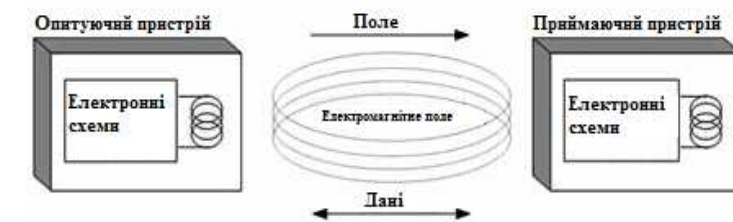
Рисунок 2 – Принцип обміну в NFC
