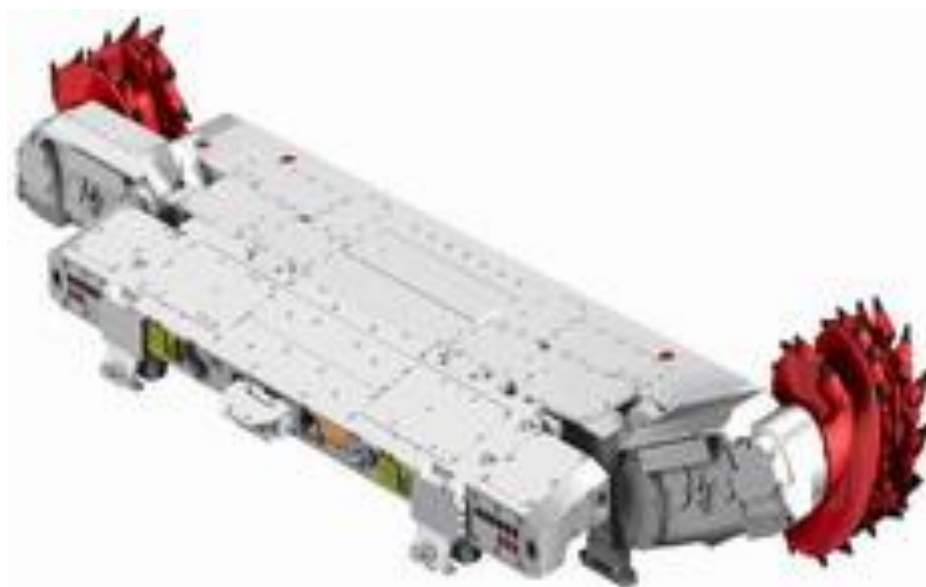
Рисунок 1 – Загальний вигляд очисного комбайну УКД 200-25, на корпусі якого червоними цятками вказано гідравлічні форсунки для подалення пилу та оснащення шнеків системою пилоподавлення зрошуванням.
