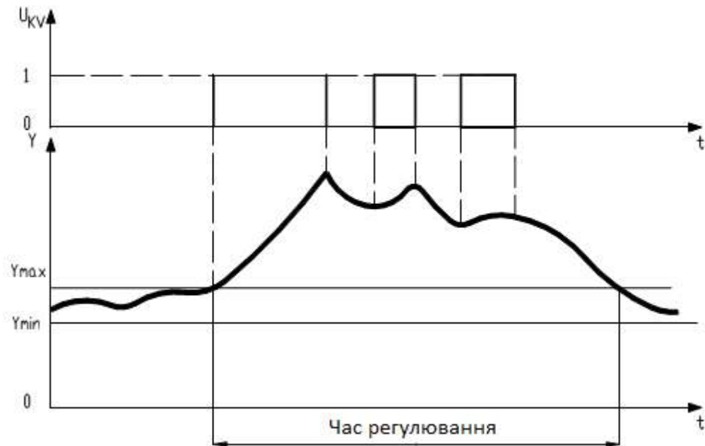
Рисунок 2.14 – Динаміка безперервного регулювання.
