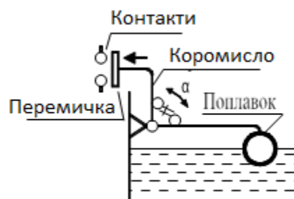
Рисунок 2.6 – Схема датчику рідини в посуді.
