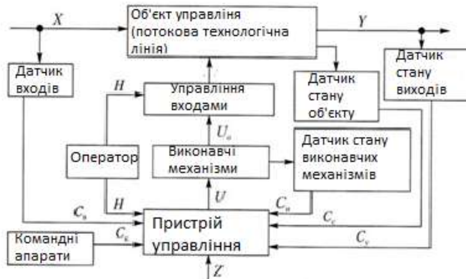
Рисунок 2.3 – Спрощена схема САУ: X - входи об'єкта; Y - стан об'єкта; U_o , U - керуючі впливи; H - ручний вплив; C_v , C_i , C_s , C_u - сигнали від датчиків, які контролюють входні і вихідні параметри об'єкта, а також стан агрегатів і пристроїв технологічної лінії; C_k - сигнали, що формуються командними апаратами; Z - мета управління.
