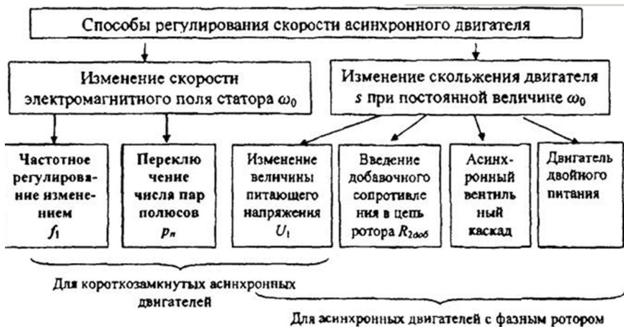
Рисунок 1.3 – Способы регулювання швидкості асинхронного двигуна
