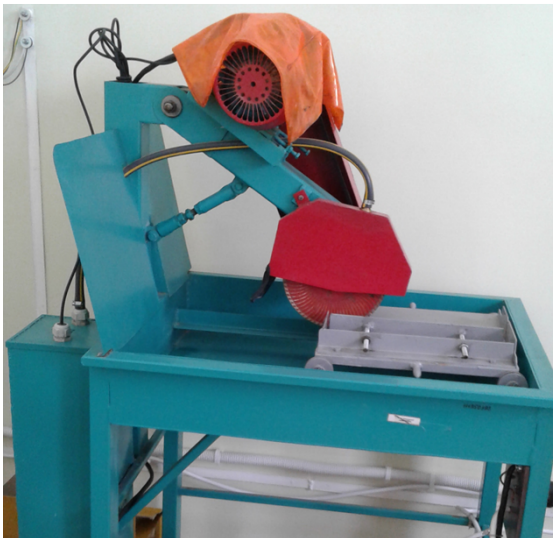
Рисунок 2.5 – Каменерізний верстат і підготовлені зразки пісковика кубічної форми.
