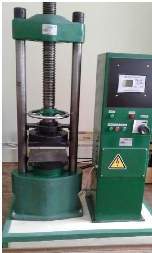
Рисунок 2.8 – Гідравлічний прес П-50 з максимальним зусиллям 50 тонн
