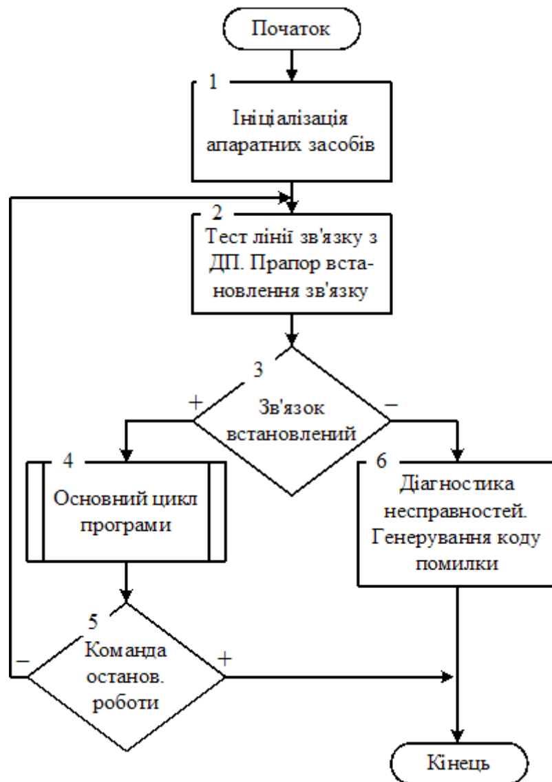
Рисунок 4.5 – Алгоритм роботи вимірювача концентрації пилю
