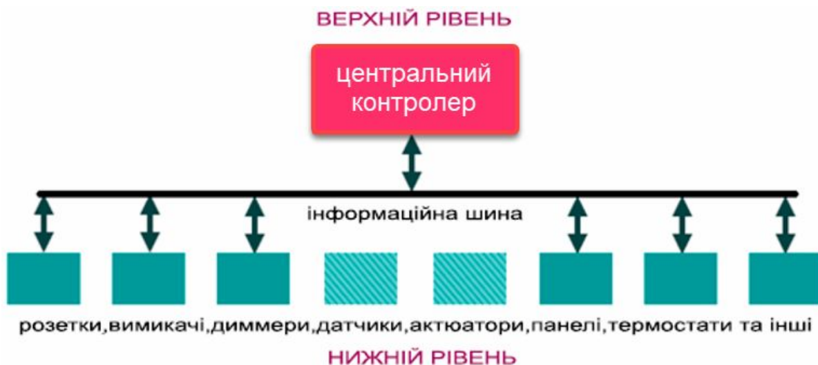
Рисунок 1 - Типова схема системи «Розумний будинок»
