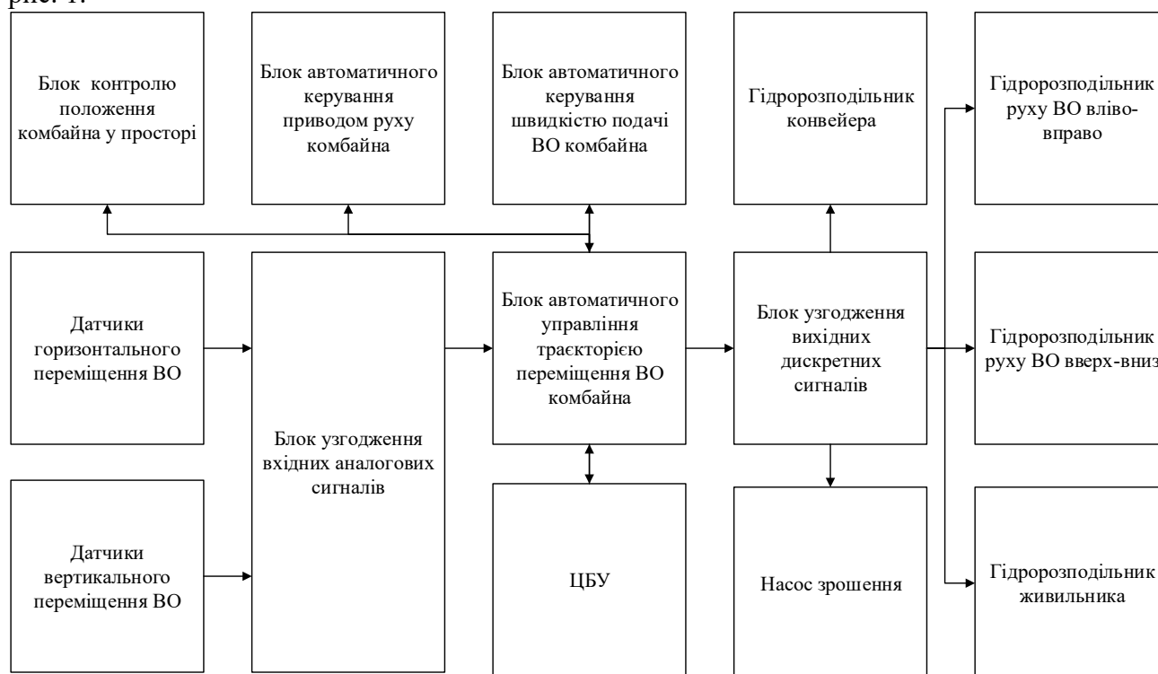
Рисунок 1 – Структурна схема системи автоматичного керування траєкторією переміщення ВО комбайна
