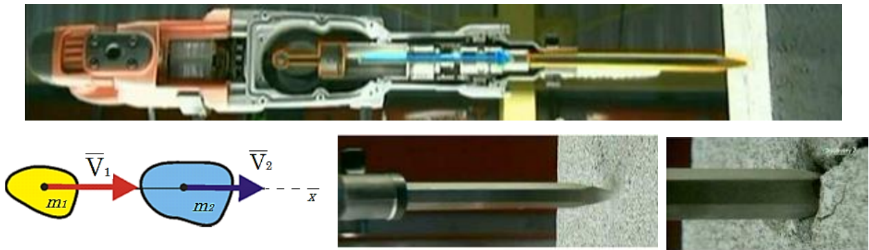
Рисунок 2 - Принцип дії ударної системи
