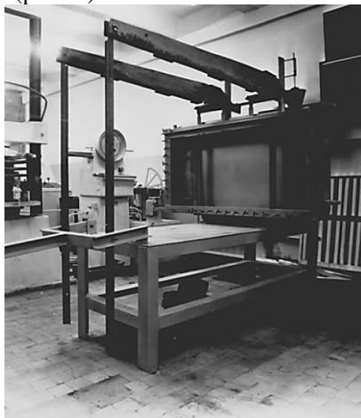
Рис. 2. Загальний вигляд плоского стенду для моделювання на еквівалентних матеріалах (Національний гірничий університет)
