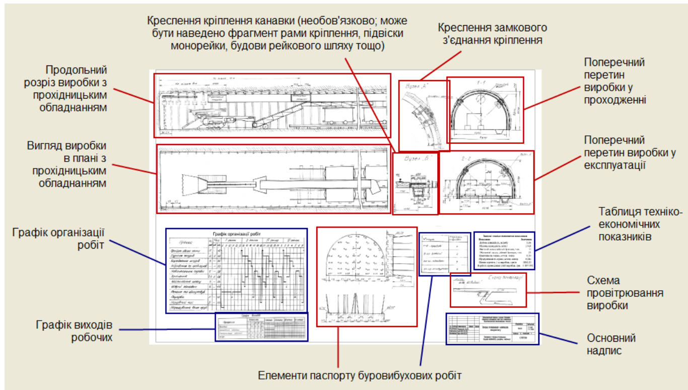
Рис. 2 – Компоновка графічної частини проекту проведення виробки з арковим рамним кріпленням (БВР)
