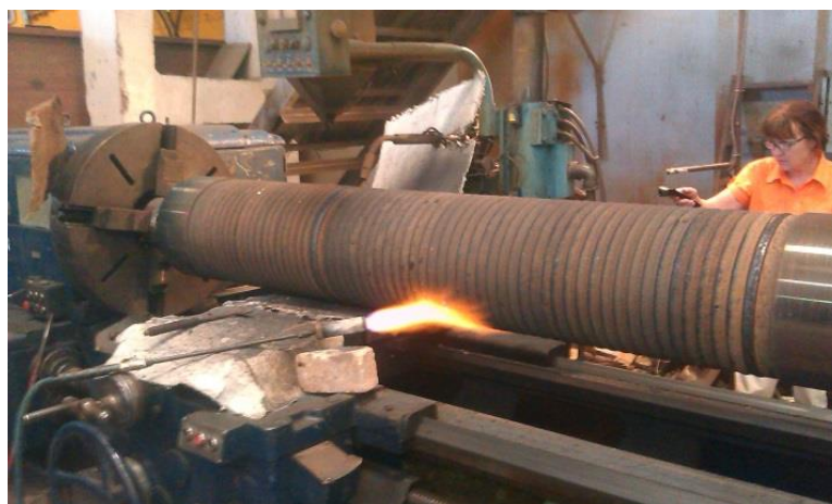
Наплавка вала МНЛЗ
