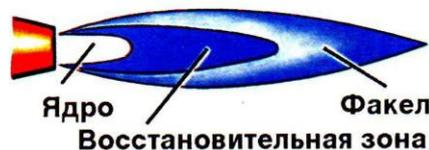
Ядро - резко очерченное, цилиндрической формы с плавным закруглением, ярко светящейся оболочкой, четко выражены все три зоны. Используют для сварки большинства сталей, сплавов и цветных металлов
