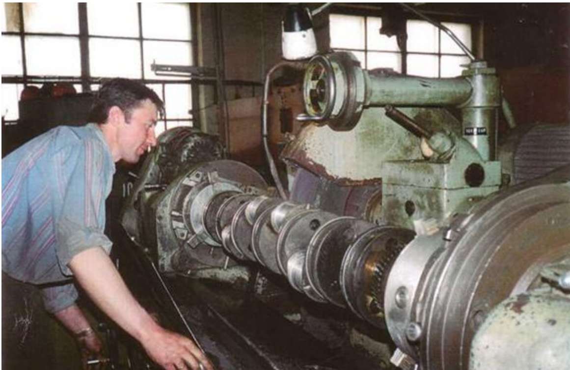
Шлифовка коленчатого вала ЯМЗ-240 после восстановления шеек
