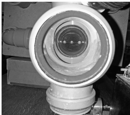
Рисунок 5 – Установка поворотной заслонки
