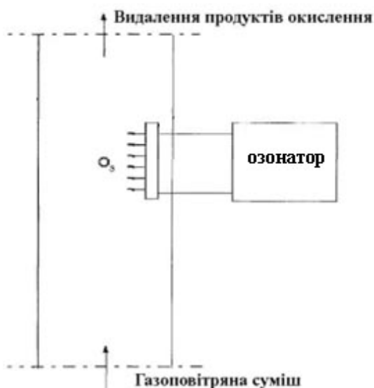
Рисунок 1 - Принципова схема озонування газоповітряного потоку
