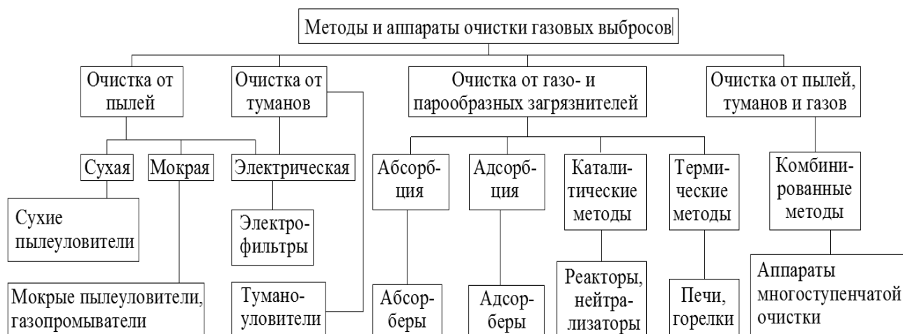
Рисунок 2 - Схема основных методов очистки промышленных выбросов
