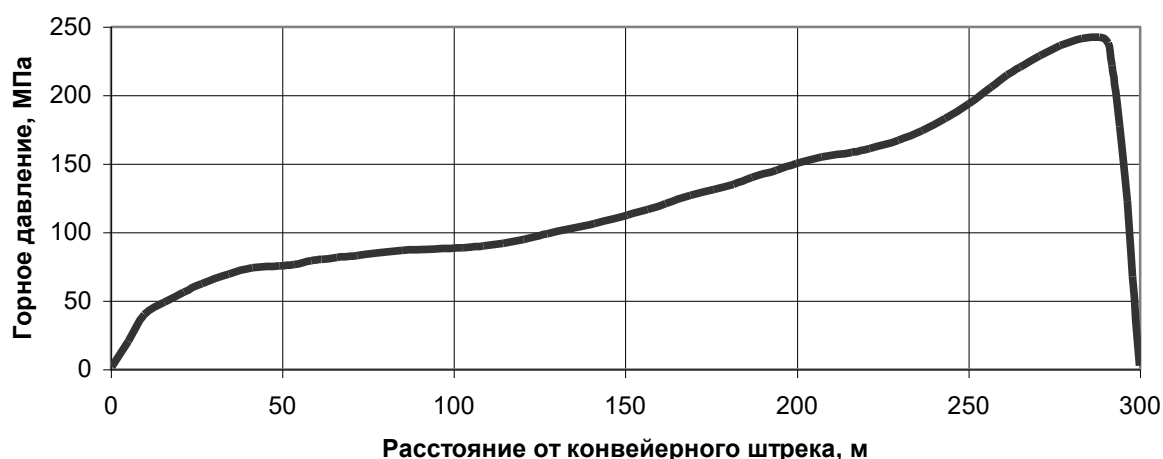
Рис. 1. Распределение горного давления по длине забоя при сплошной системе разработки во 2-й лаве центрального бремсберга пласта l_1
