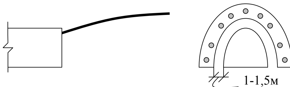
Рисунок 5.15 — Создание зоны разгрузки вокруг выработки.
