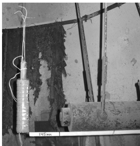
Рис. 1. Общий вид лабораторной установки перед взрыванием заряда
