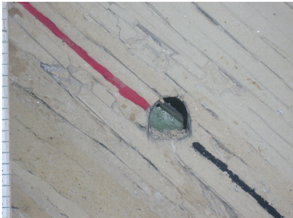
Рис. 2. Сдвижение боковых пород в окрестности штрека при охране широкой податливой опорой
