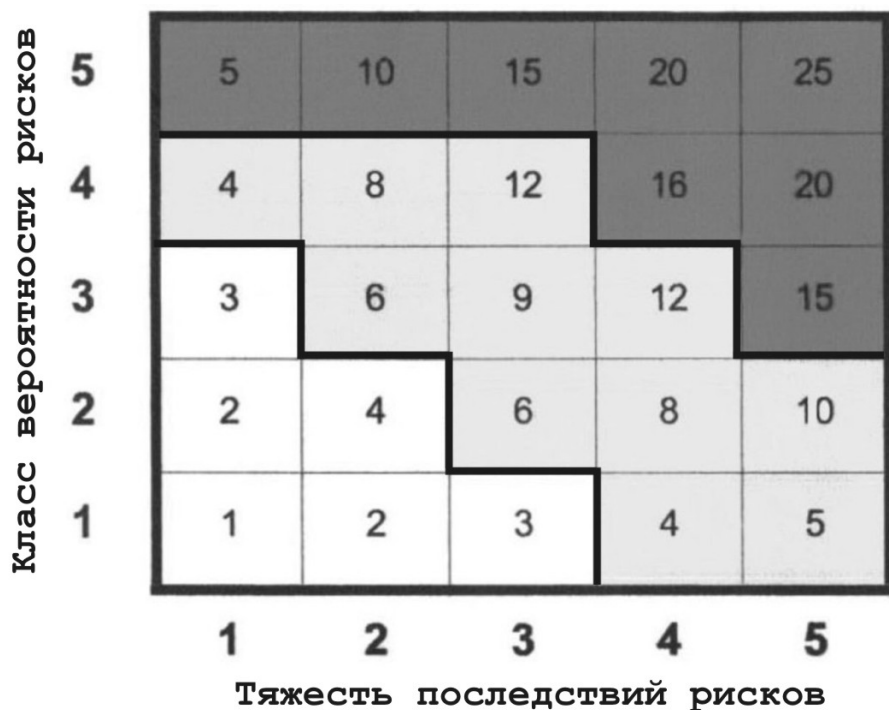
Рис. 8.4. Результаты оценки рисков при строительстве канализационного туннеля Fall Creek/White River белые поля – низкий риск; серые поля – средний риск; темные поля – высокий риск
