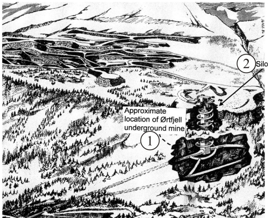
Рис. 3.19. Схема подземных работ шахты Ortfjell
