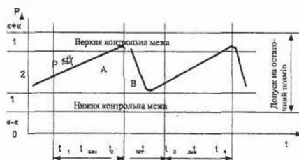
Рисунок 5.16 – Зміна контрольованого параметра в процесі автоматичного підналадження
